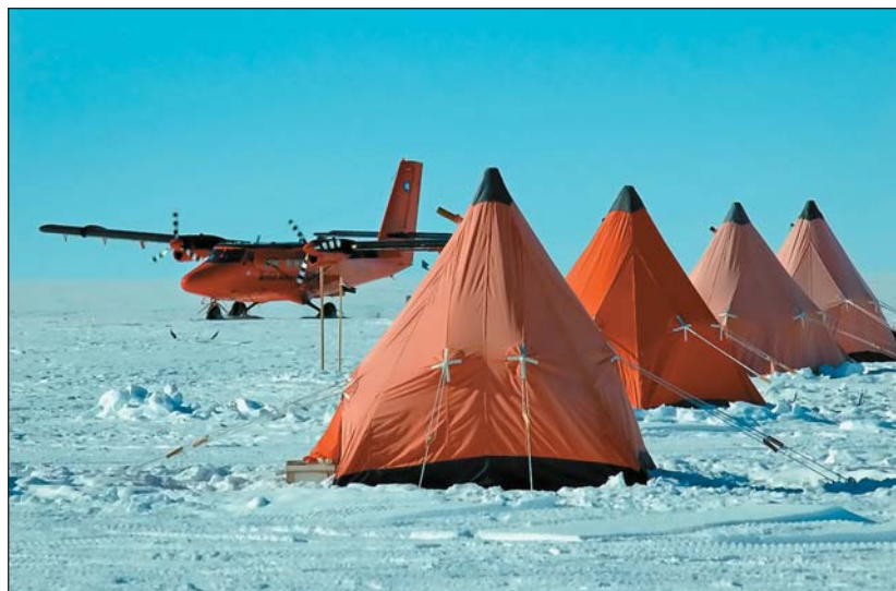
Сезонная база North AGAP. На базе лыжного варианта самолета Twin Otter Британской антарктической службы (BAS) установлены радарные, магнитные и гравитационные датчики.
