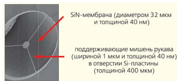
Рис.6. Пример ограниченной нано-микроразмерной мишени для экспериментов по лазерному ускорению ионов (Резерфордская лаборатория, Великобритания).
